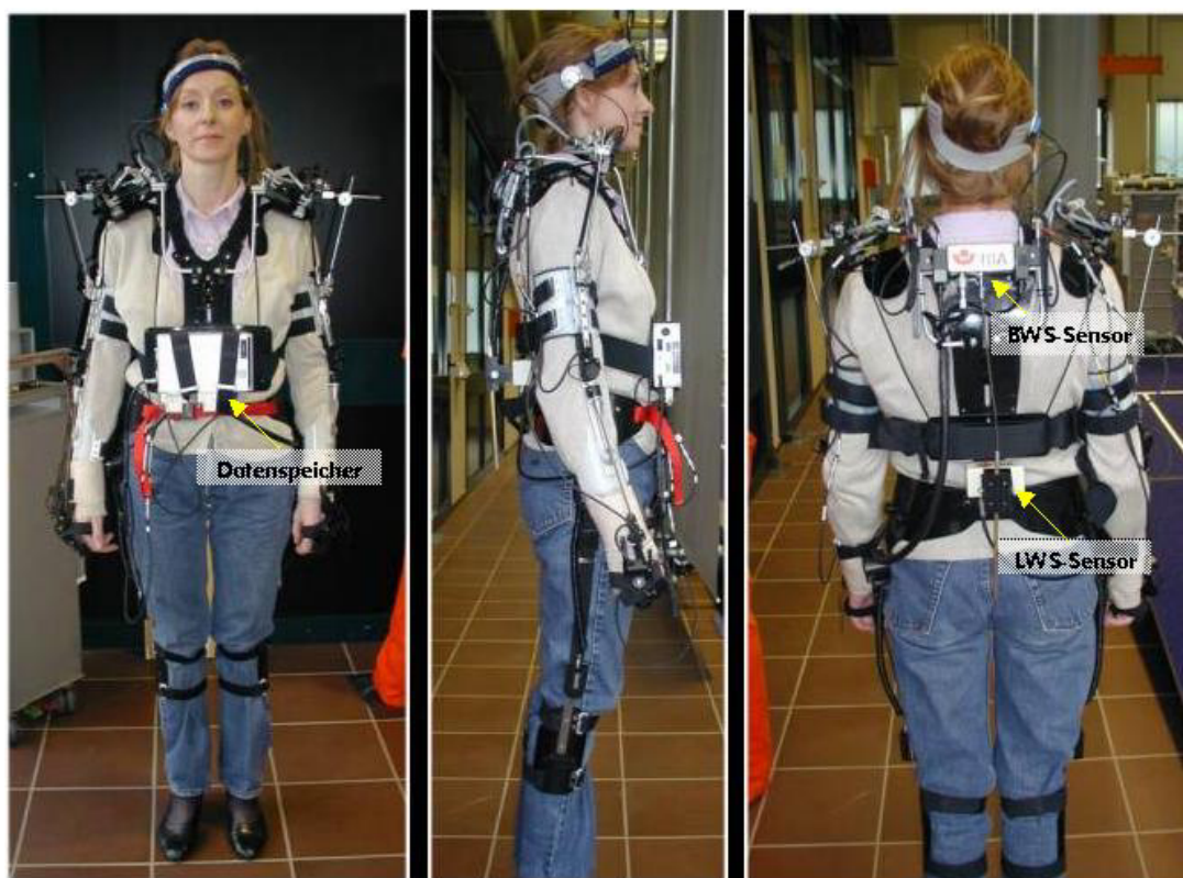
Abbildung 5-15: Versuchsperson mit angelegtem CUELA-Messsystem
